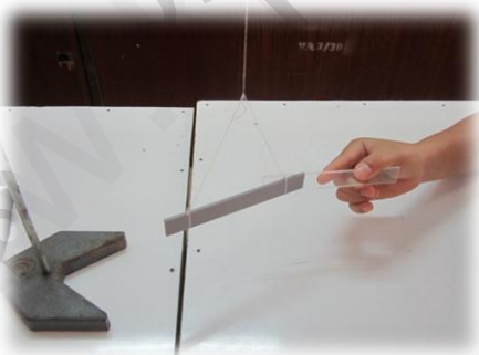
ค. รูปแผ่นพีวีซีกับแผ่นเปอร์สเปกซ์ดูดกัน
