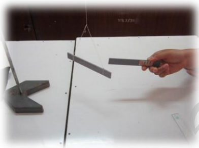
ก. รูปแผ่นพีวีซีกับแผ่นพีวีซีผลักกัน
